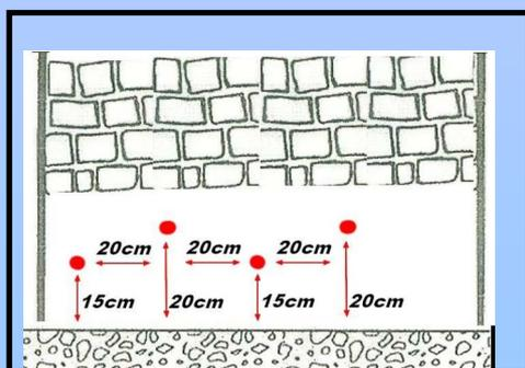
Percez les trous jusqu'à 75% de l'épaisseur du mur.
